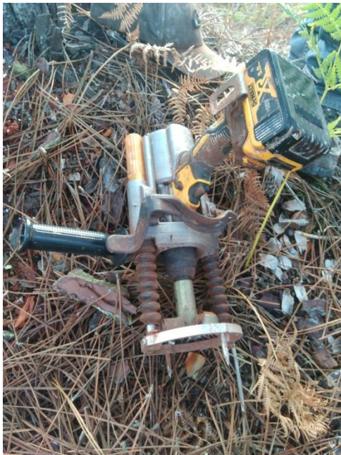
Figure 5 : Outil de piquage utilisé dans la méthode Biogemme
