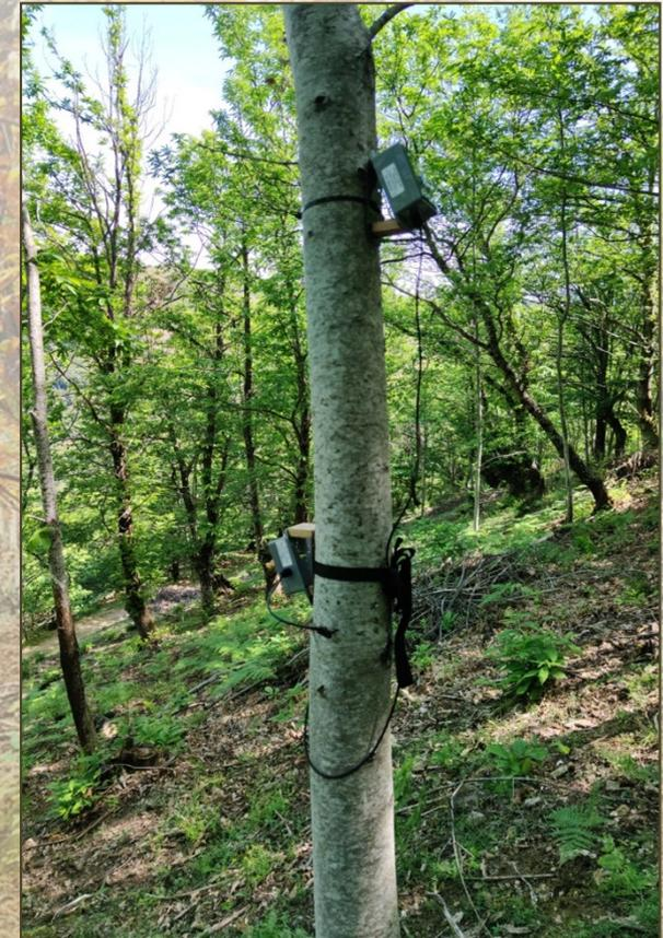
*Vista detalle del coordinador central GPRS o Gateway (izda.), y de la instalación de los sensores Treetalker (TT+) en los árboles seleccionados, con afección por *Chryponectria parasitica* (centro) y sin afección (dcha.)*
