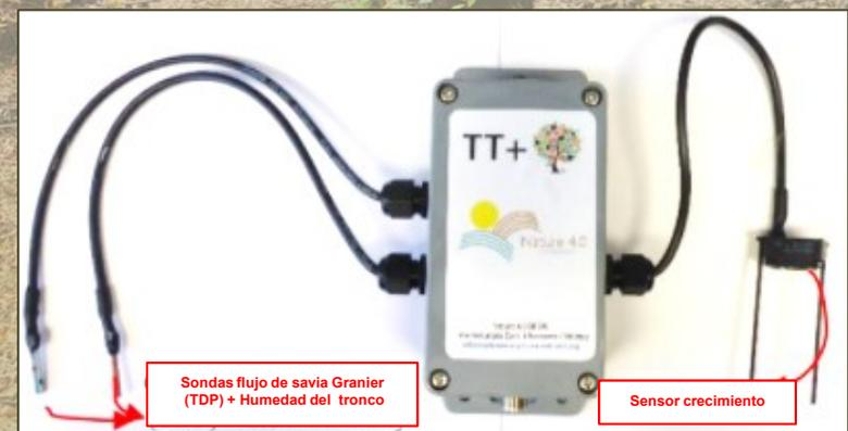
*Esquema de funcionamiento del TreeTalker (arriba izda.) y detalle de los diferentes componentes que lo integran.*
